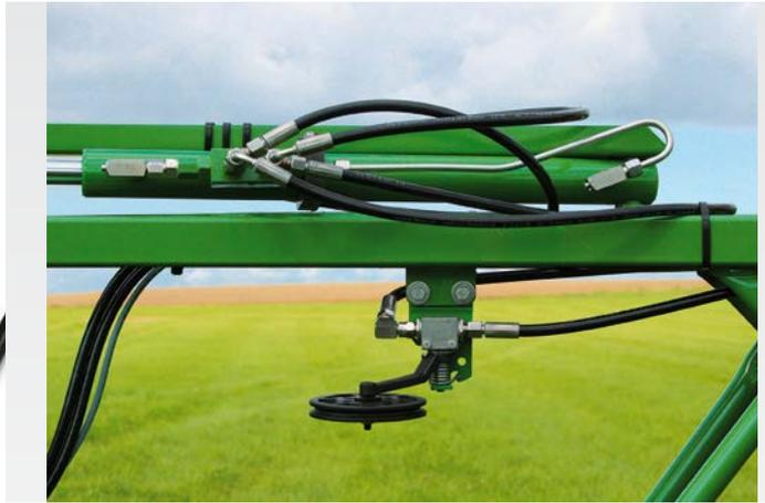
✔ I raccordi idraulici in acciaio inox assicurano una lunga durata e un elevato valore di rivendita.
