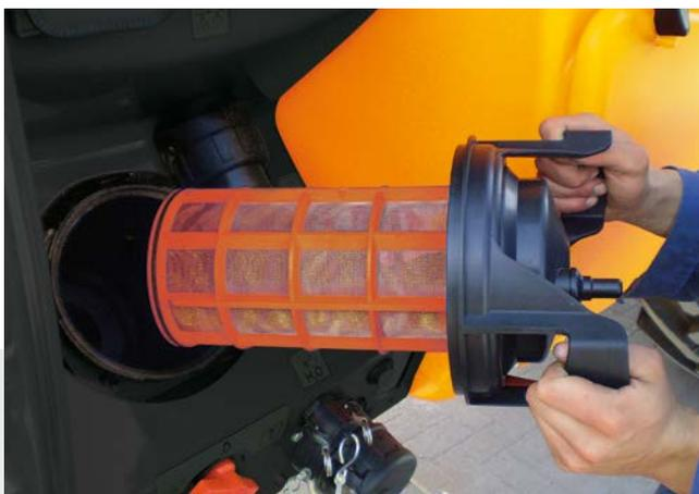
Il filtro di aspirazione si può aprire e pulire a macchina piena senza perdite di liquido di irrorazione.
