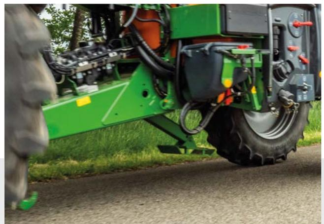
Barra di traino inferiore con piede di parcheggio idraulico
