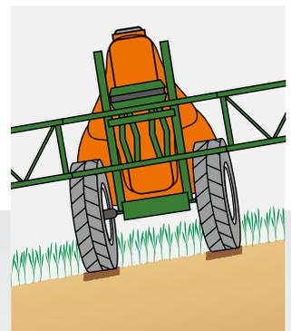
Compensazione pendenza dello sterzo AutoTrail attivata
