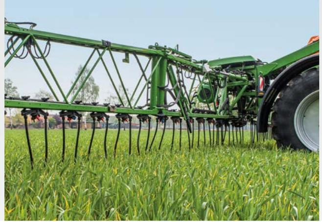
Equipaggiamento di tubi a strascico con corpo ugello quadruplo
