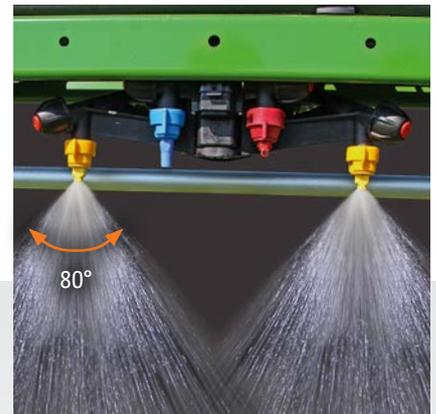
Il controllo elettrico dei singoli ugelli AmaSelect con corpo ugello quadruplo e distanza di 50 cm o 25 cm tra gli ugelli
