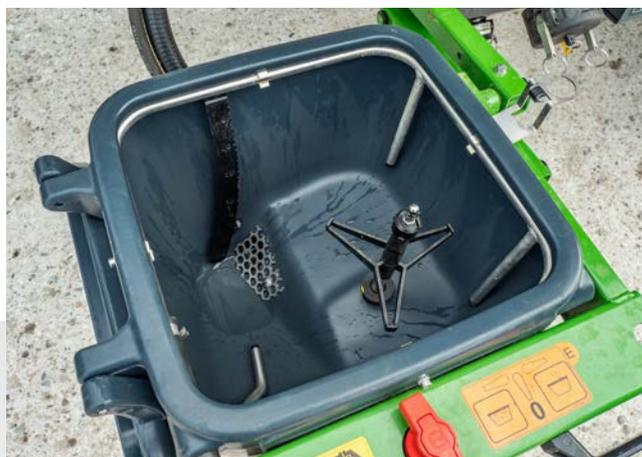
Il potente incorporatore assicura tempi di riempimento minimi e una miscelazione omogenea del liquido di irrorazione
